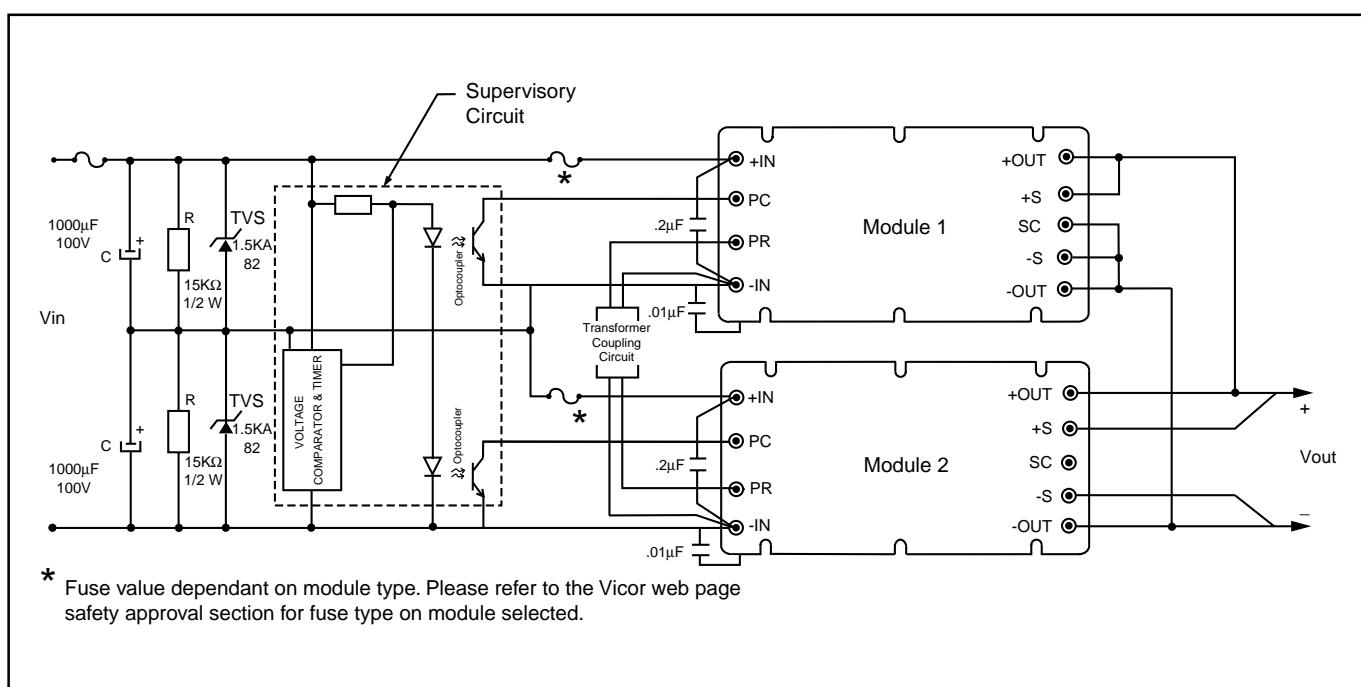
图1 基本的串联输入配置
