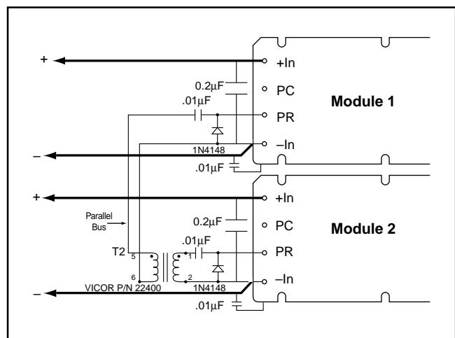
图3：变压器耦合电路
